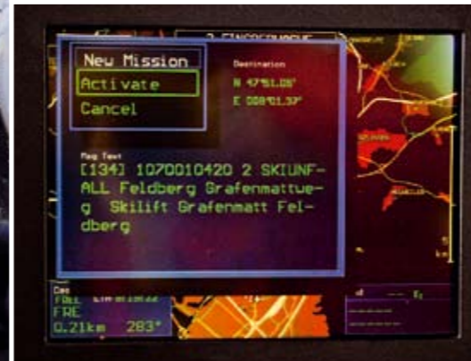
Nonverbale Kommunikation auf Knopfdruck: Durch Bestätigung der Taste „Activate“ nimmt die Hubschrauber-Crew den Einsatz an.
