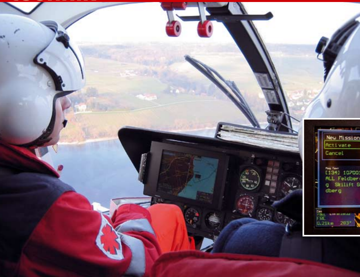
Die Koordinaten des Einsatzortes sowie Details zum Einsatz können von der Leitstelle direkt in das Navigationssystem des Rettungshubschraubers übermittelt werden.
