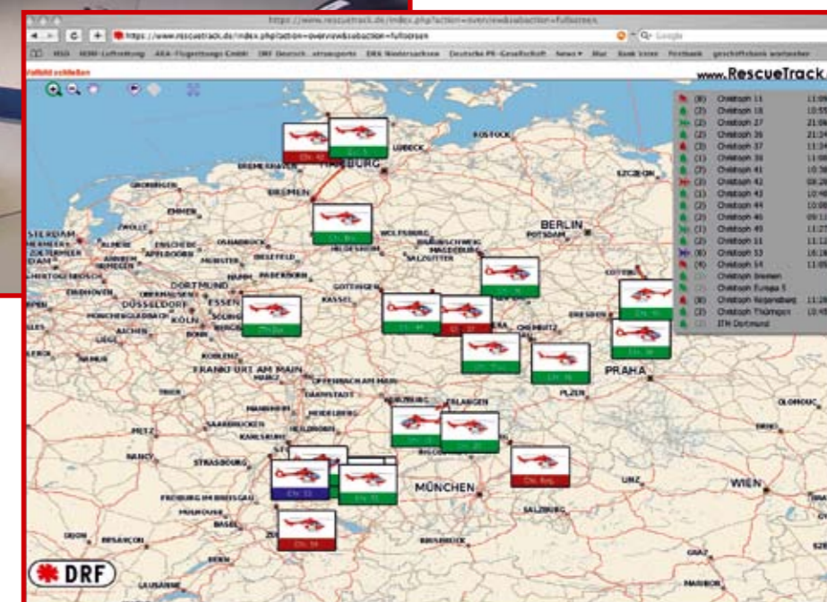
Der Startbildschirm von RescueTrack zeigt die Einsatzhubschrauber in der Übersicht. Zooms bis auf Straßenebene sind möglich. Oben rechts: Die Legende zeigt die Funkrufnamen der Rettungshubschrauber, deren Einsatzstatus sowie die Uhrzeit an, zu welcher der letzte Status gesetzt wurde. Die Daten werden alle zwei Minuten aktualisiert.
